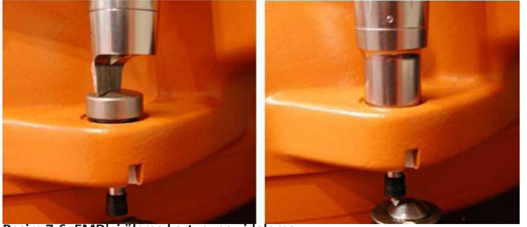
Resim 7-6: EMD'yi ölçme kartuşuna vidalama
