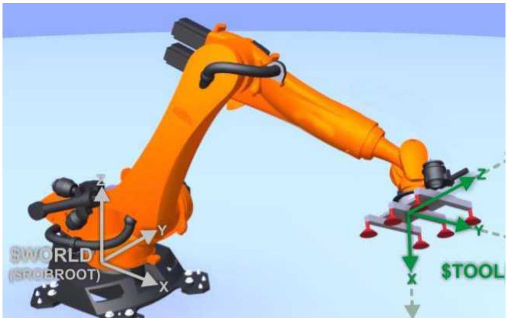
Resim 6-14: Robot Tool koordinat sistemi
