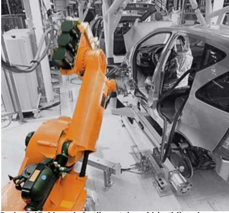
Resim 2-17: Montaj - lastik contaların birleştirilmesi
