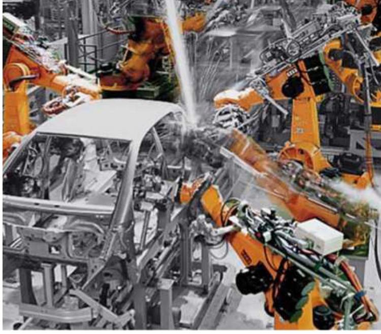
Resim 2-6: Bir kaportanın nokta kaynak işlemi
