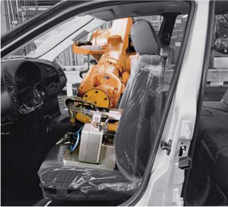
Resim 2-18: Otomobil koltuklarının montajı
