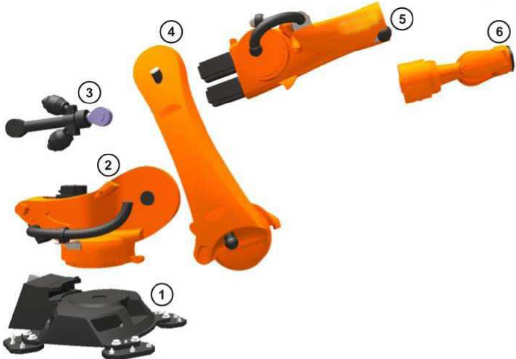
Resim 4-4: Robot mekanik sistemi komponentlerine genel bakış
